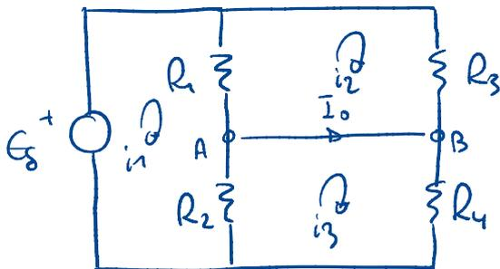
$$B \quad i_0 + i_2 = i_3 \Rightarrow i_0 = i_3 - i_2$$
