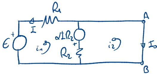
$$i_1 \rightarrow -E - \alpha I R_2 = i_1 (R_1 + R_2) - i_2 R_2 \xrightarrow{i_1 = I}$$
