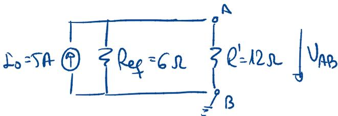
$$I_0 = V_{AB} \left( \frac{1}{R_{eq}} + \frac{1}{R'} \right) \rightarrow V_{AB} = I_0 \left( \frac{R_{eq} \cdot R'}{R_{eq} + R'} \right)$$
