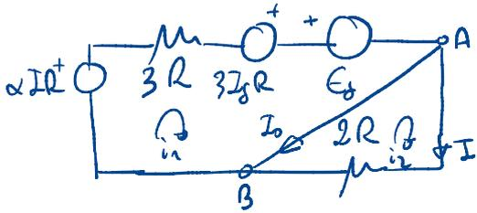
$$i_1 \alpha IR + 3I_0 R - E_0 = i_1 3R \rightarrow 3I_0 R - E_0 = i_1 3R - i_2 R^*$$
