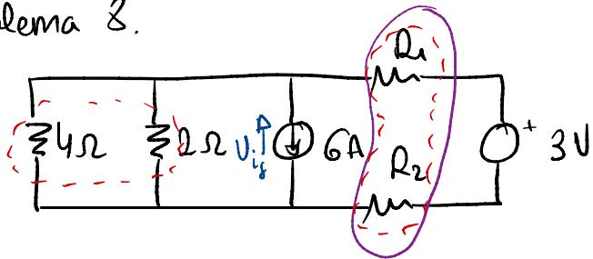
Potencia consumida por  $R_1$  y  $R_2$  si fuente de intensidad genera 24 W
