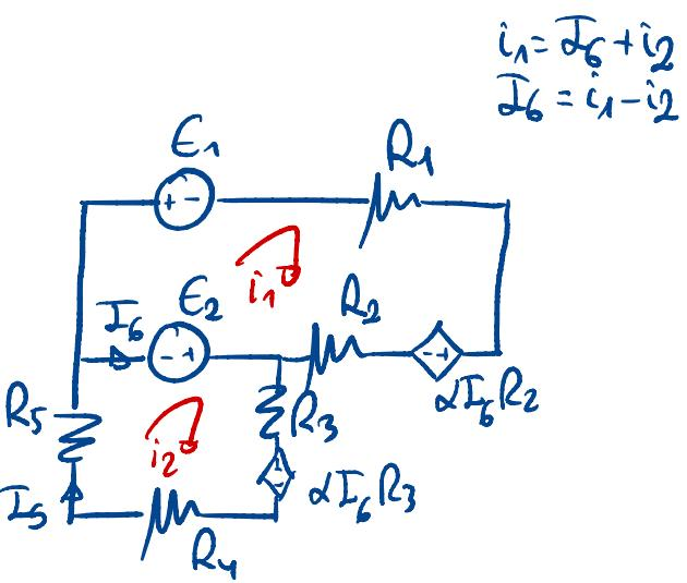
$$i_1 \rightarrow -E_1 - \alpha I_6 R_2 - E_2 = i_1 (R_1 + R_2) \xrightarrow{I_6 = i_1 + i_2} -E_1 - E_2 = i_1 (R_1 + R_2(1+\alpha)) - i_2 \alpha R_2$$
