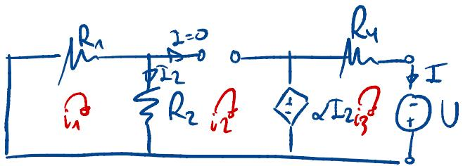
$$i_1 \rightarrow 0 = i_1(R_1 + R_2) - i_2 R_2^{\circ} \rightarrow i_1 = 0$$
