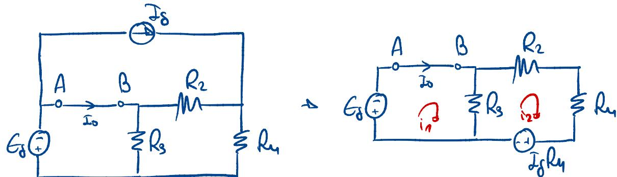
$$i_1 - E_s = i_1 R_3 - i_2 R_3$$
