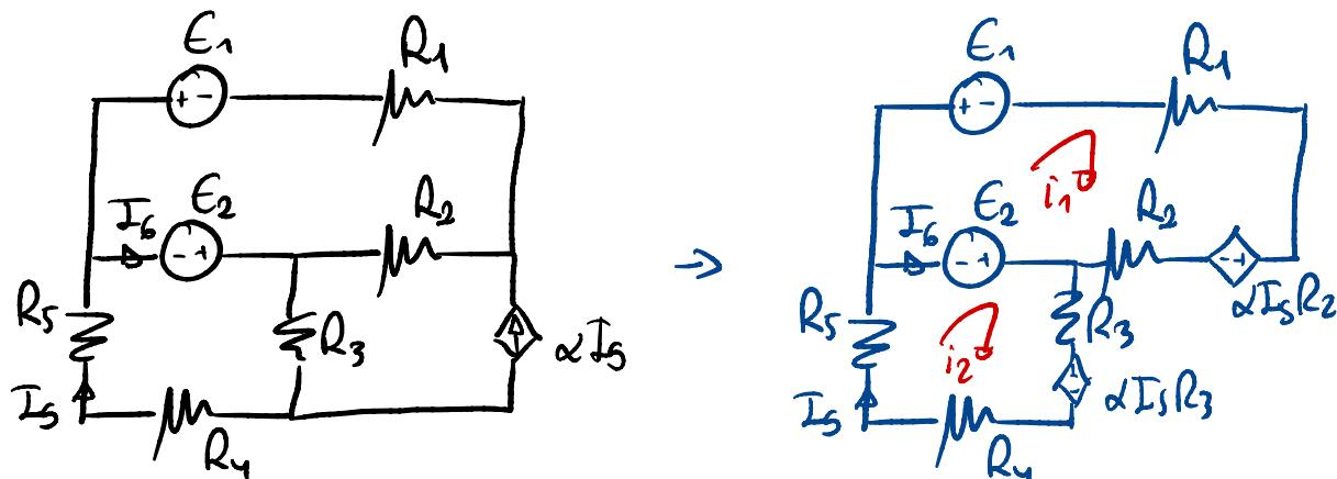
$$\text{a)} -E_1 - \alpha I_s R_2 - E_2 = i_1 (R_1 + R_2) \xrightarrow{i_1 = i_2} -E_1 - E_2 = i_1 (R_1 + R_2) + i_2 \alpha R_2$$
